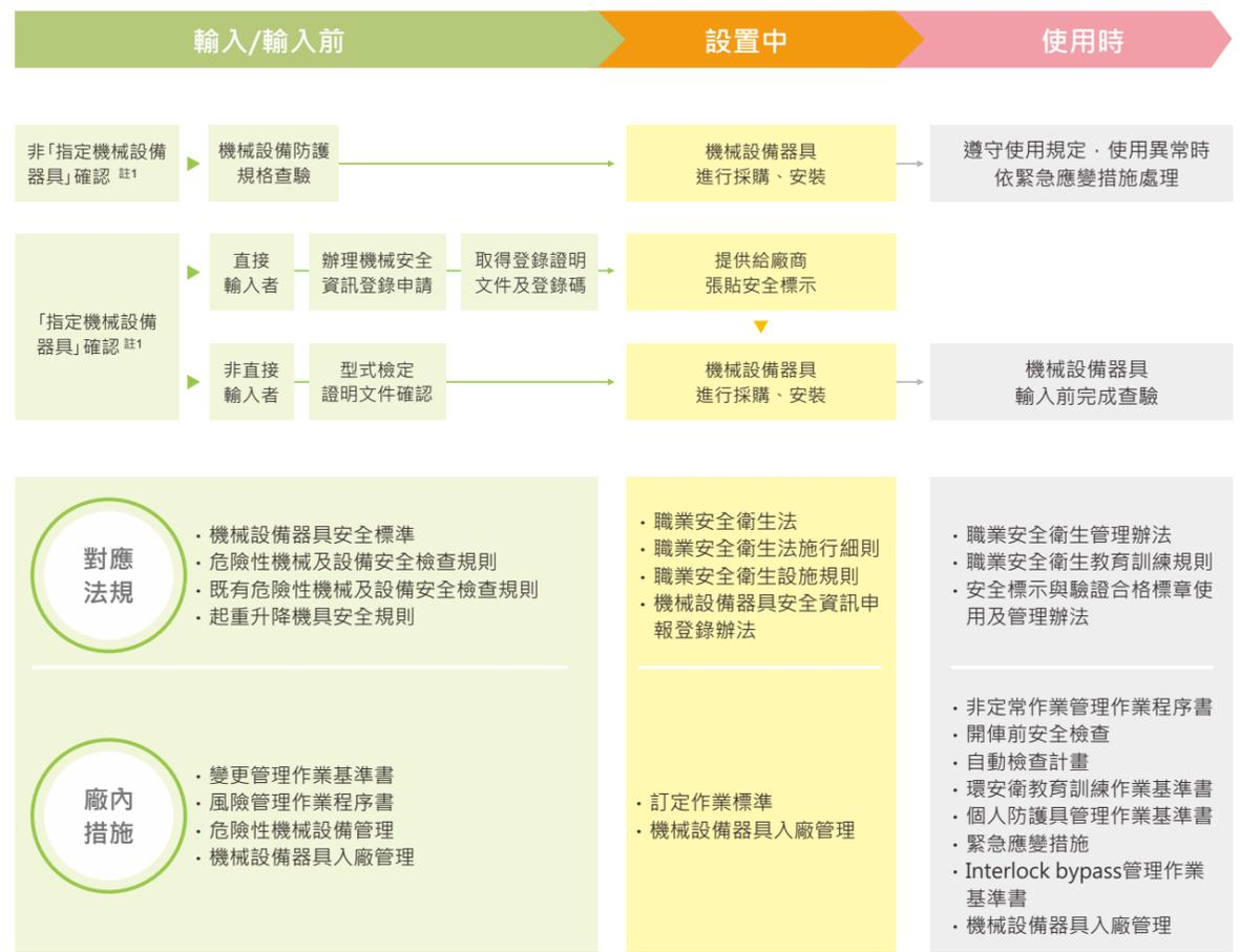
註1：包含動力衝剪機械、手推刨床、木材加工用圓盤鋸、動力堆高機、研磨機、研磨輪、防爆電氣設備、動力衝剪機械之光電式安全裝置、手推刨床之刀部接觸預防裝置、木材加工用圓盤鋸之反撥預防裝置及鋸齒接觸預防裝置、其他經中央主管機關指定公告者
